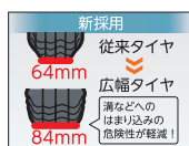
新採用 従来タイヤ 広幅タイヤ 溝などへの はまり込みの 危険性が軽減！
